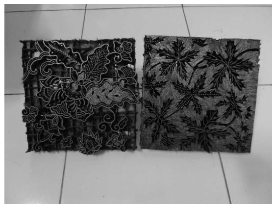
【写真3：チャップ製法に使う銅製スタンプ】
